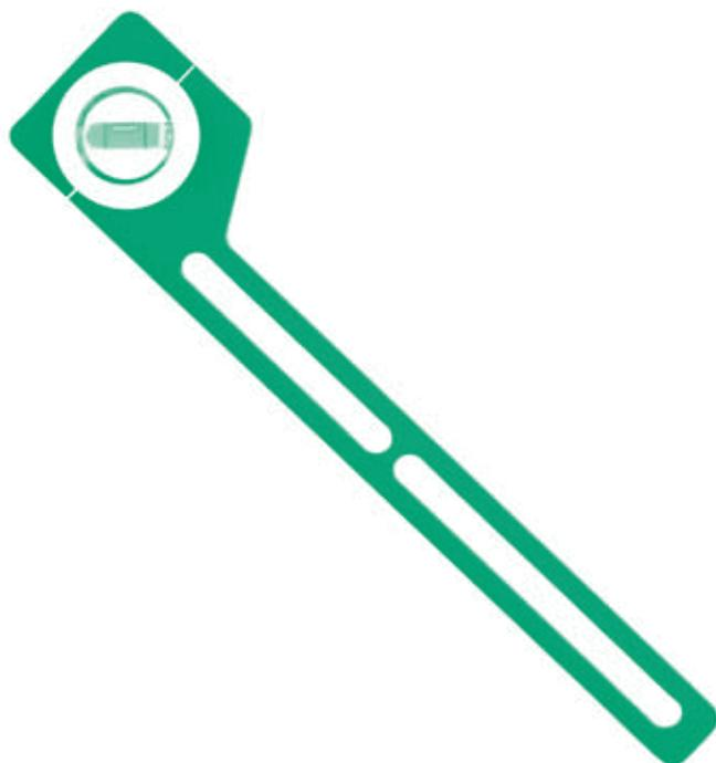
Для прокладки и контроля наклона трубопроводов и др. С магнитными поверхностями прилегания для крепления на любых ровных поверхностях труб или на гладких плоскостях. Прибор имеет поворотный пузырьковый уровень для измерения угла. Угол и наклон легко без пересчета определяются и устанавливаются по шкале. Материал: анодированный алюминий.
