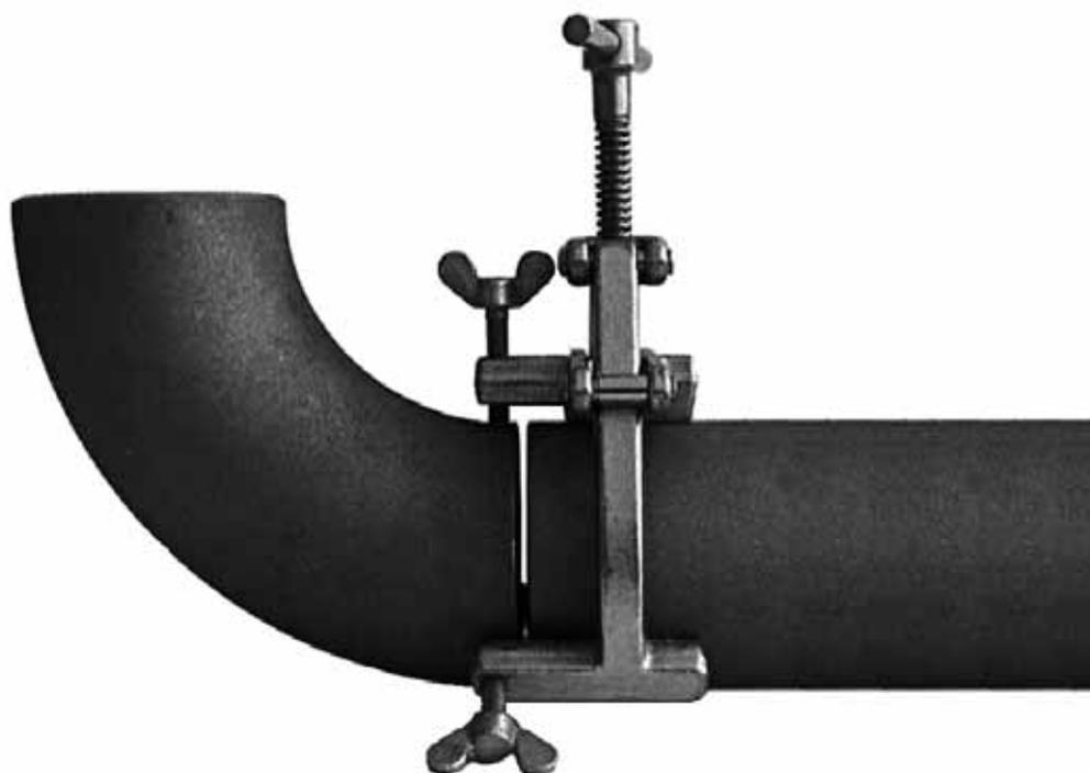
Для точного центрирования и зажима труб неограниченной длины, а также трубных колен, фланцев, тройников, переходников и другой трубной арматуры. Работы можно выполнять без помощников. Места сварки доступны со всех сторон. Точная подгонка труб осуществляется барашковыми винтами.
